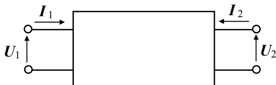
1.149 pav. Keturpolio žymėjimas elektroninėse grandinėse ( čia kaip ir anksčiau elektrinių signalų parametrų pajuodintas šriftas atitinka jų laikinių diagramų harmoninį pavidalą )
