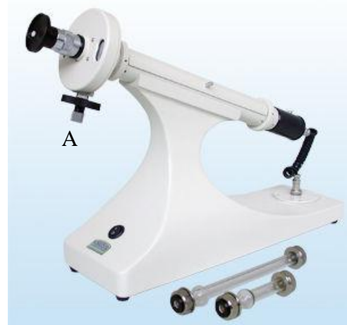
7.5.1 pav. Poliarimetro ir kiuvėčių išorinis vaizdas
