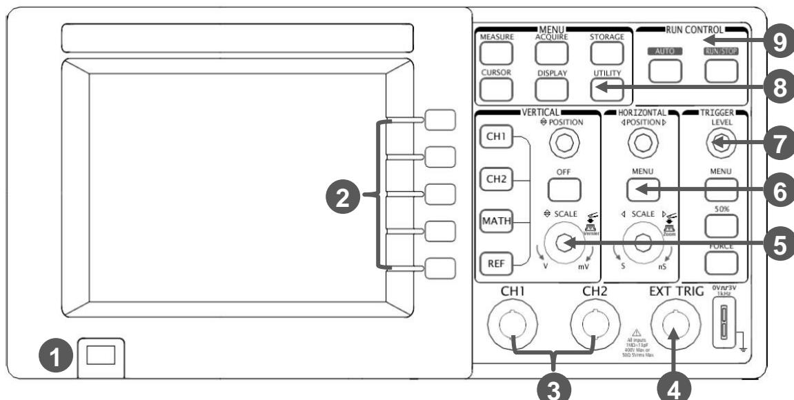
5 pav. Oscilografo Rigol DS5102C valdymo panelės schema
